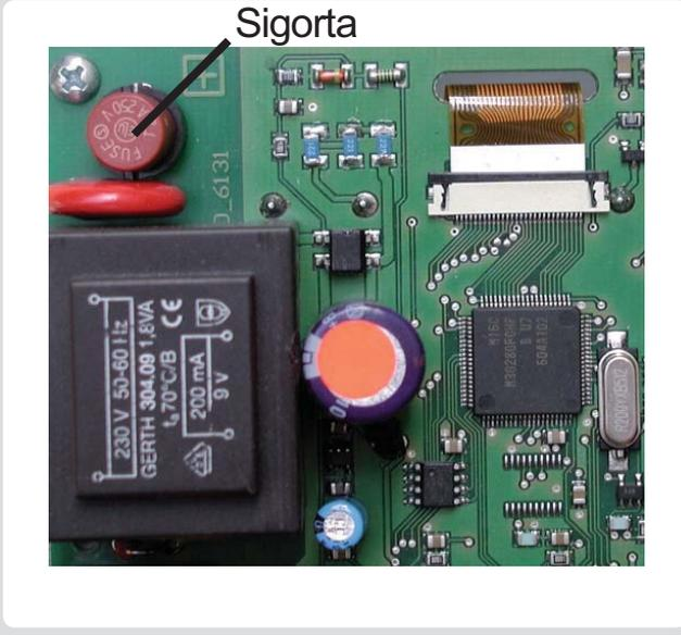
Kumanda cihazına enerji verdiğiniz halde cihaz çalışmıyor veya ekranında herhangi birşey çıkmıyorsa, cihaz içerisindeki sigorta atık olabilir. Bu durumda, C kısmı altında tarif edildiği üzere cihazı açınız ve eski sigortayı sökerek kontrol ediniz. Atık sigortayı yenisi ile deęiştirin, sigorta atmasına neden olan harici cihazı tespit edin (ör. pompa) ve deęiştirin. Kumanda cihazını devreye alın ve cihaz çıkışlarının fonksiyonlarını bölüm 4.2 altında açıklandığı üzere manuel modda kontrol ediniz.
